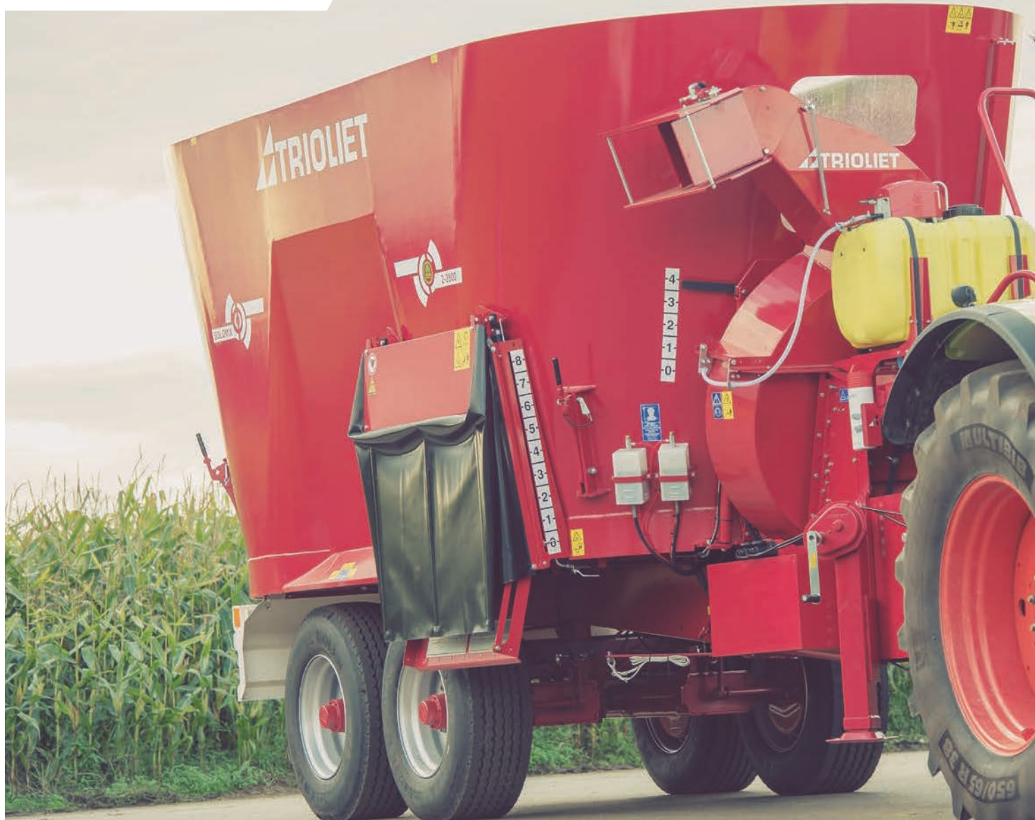
Solomix P2 稻草鼓风机，带喷雾装置，可减少灰尘。
